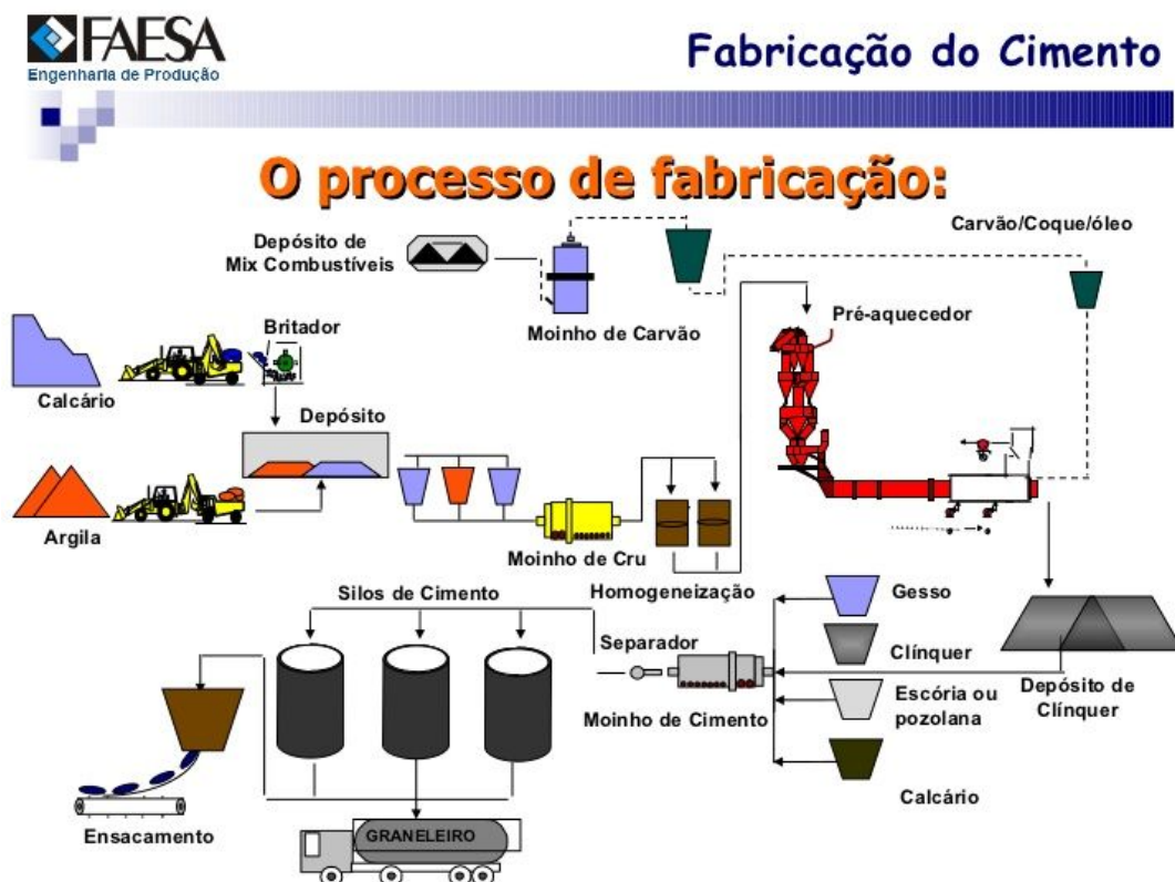
Figura 1 - Fluxograma representativo do processo de produção de cimento. Fonte - Magnavita, Bourguignon, Correa, De Souza, Dos Santos, 2009, Slide 9
