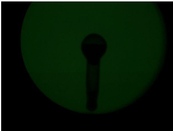
Figura : Radiografia de uma amostra de mercúrio em uma pequena ampola de vidro
