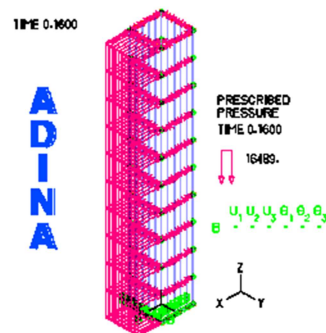
Figura 12 – Malha de elementos com vínculos e carregamentos impostos
