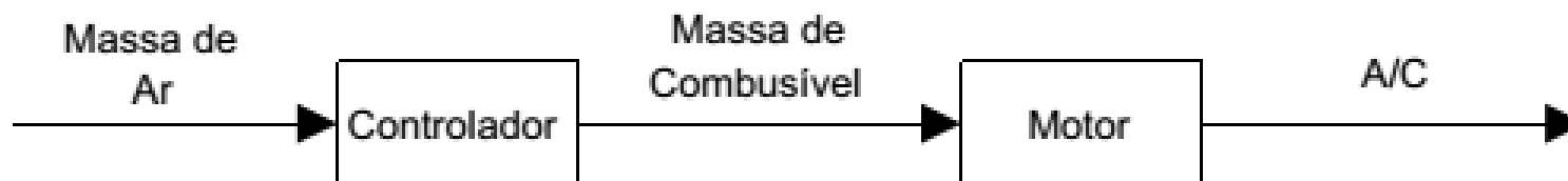
Figura 9 – Diagrama de blocos do sistema em malha aberta.
