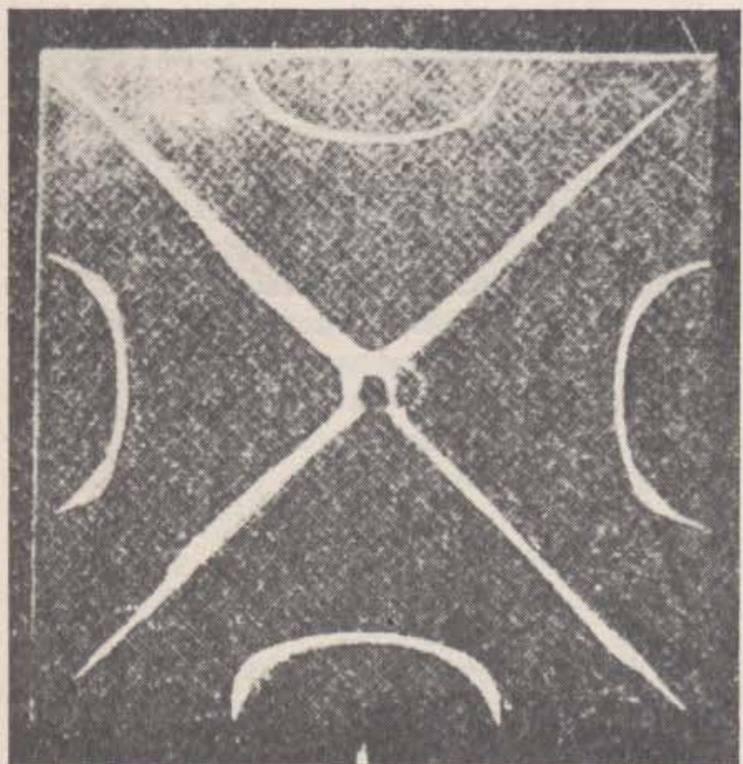
b) Forma de onda estacionária em uma placa de metal presa pelo centro. Essas ondas (também chamadas figuras de Chladni) são formadas por areia fina espalhada sobre a placa quando esta é posta a vibrar. A areia se acumula nas linhas nodais.
