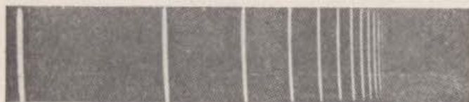
b) Fotografia das primeiras doze linhas da série de Balmer produzidas pelo hidrogênio luminescente.
