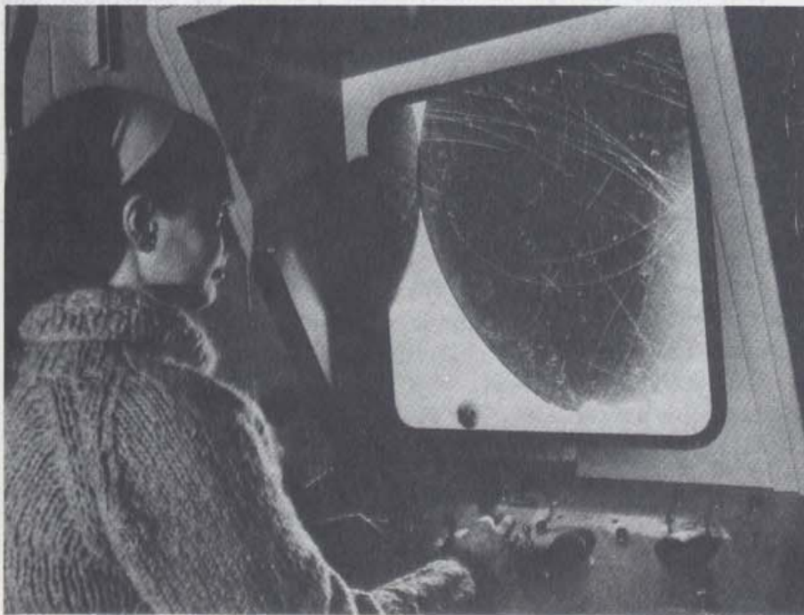
Fig. 1.11 Carretel de uma máquina carregada. O filme do rolo à esquerda é guiado através de dispositivos mecânicos, passado na abertura superior, onde é exposto às imagens da bolha provenientes da lente fotográfica. O mecanismo deve avançar em cada segundo \approx 6 polegadas de filme de 70 mm. O filme deve estar muito plano a fim de evitar distorção; é então puxado para trás contra uma placa metálica por um sistema de vácuo.
