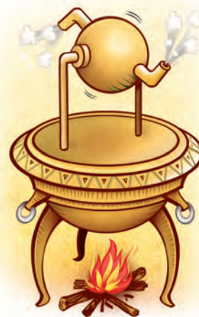
Representação do funcionamento de uma máquina de Heron.
