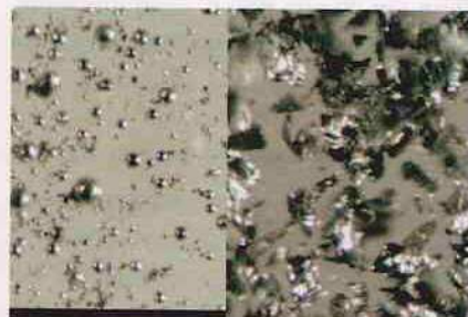
Figura 4 - Vista, em lupa estereoscópica (50 X), do aspecto de liga de amálgama de partículas esféricas (esquerda), que exige menor proporção de Hg na trituração, devido à maior compactação e menor área de contato, e vista do aspecto de liga de partículas em forma de aparas (direita).
