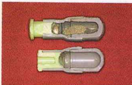
Figura 3 - Cápsula de amálgama em corte evidenciando os dois compartimentos separados por uma membrana (acima) e, depois de ativada, evidenciando o rompimento da membrana (abaixo).
