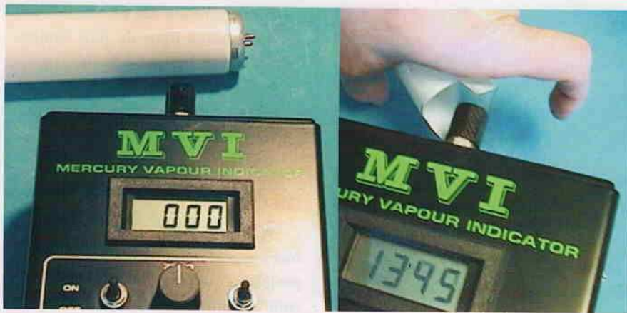
Figura 12 - O detector de vapor de Hg acusa 0 \mu\text{g}/\text{m}^3 de vapor de mercúrio antes de quebrar uma lâmpada fluorescente e 1.345 \mu\text{g}/\text{m}^3 após a quebra da lâmpada.
