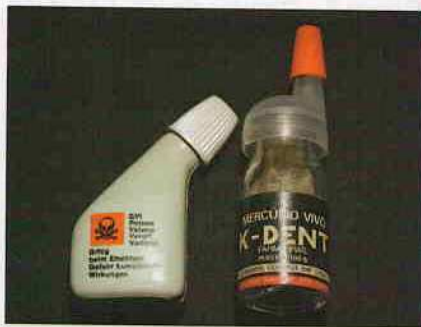
Figura 1 - Duas apresentações de frascos contendo mercúrio. O da esquerda é conforme com as recomendações de segurança: de plástico, inquebrável, hermeticamente fechado e com aviso de "material venenoso" bem visível. Já o da direita, de vidro, quebrável, sem fecho hermético.
