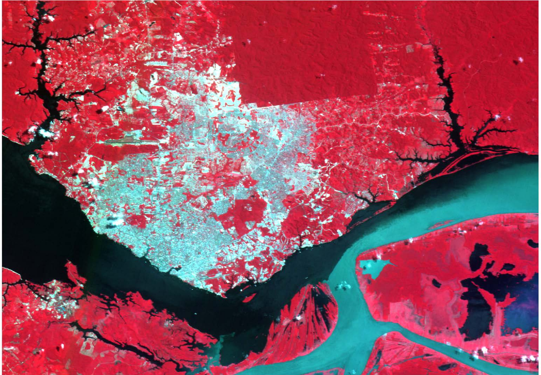
imagem CBERS 2 CCD da região de Manaus - AM composição colorida 4 (R), 3 (G), 2 (B) - órbita 173/103 data 17/08/04
