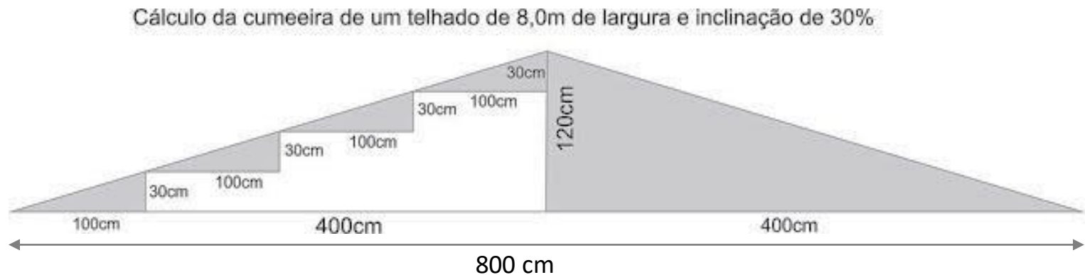
Figura 75: Inclinação de telhado. Fonte: Acervo do pesquisador.
