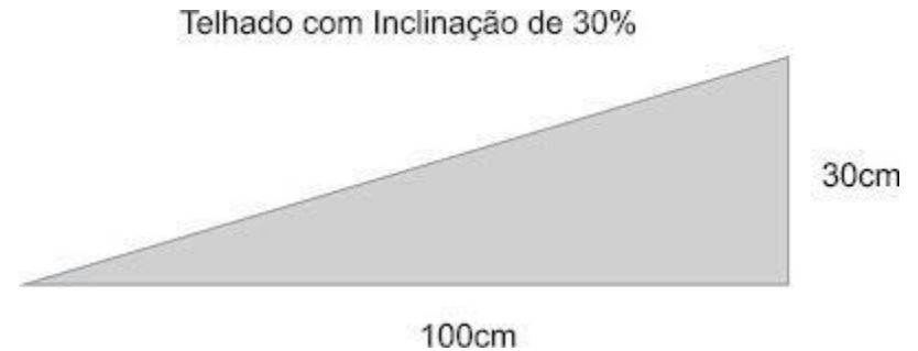
Figura 74: Inclinação de telhado. Fonte: Acervo do pesquisador.
