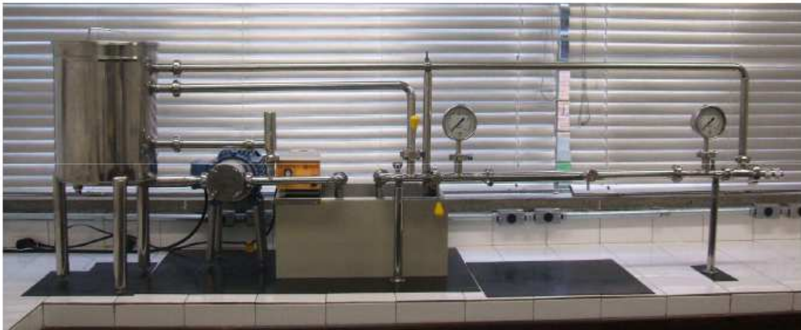
FIGURA 3.2 – UNIDADE EXPERIMENTAL DE MICROFILTRAÇÃO, EMULTEC – UFPR.
