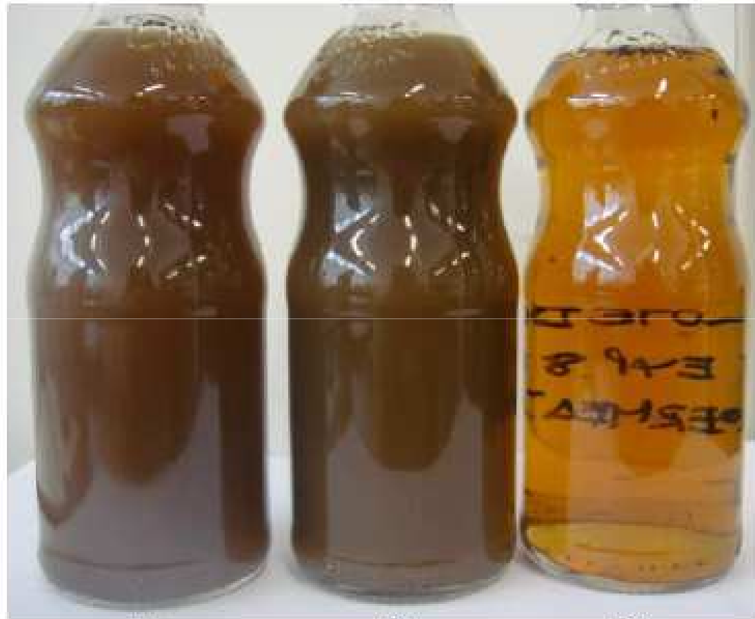
FIGURA 4.10 – AMOSTRAS DE CALDO DE CANA IN NATURA (A); RETENTADO (B) E PERMEADO (C).
