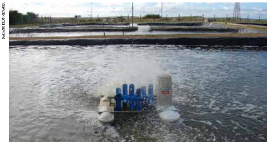
FIGURA 2 | AERADORES DO TIPO PADDLE WHEEL EM VIVEIROS; ESTAÇÃO MARINHA DE AQUACULTURA/IO/FURG, RS, 2011
