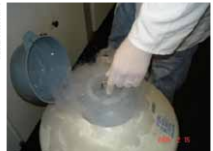
FIGURA 4 | BOTIJÃO DE ESTOCAGEM DE SÊMEN CRIOPRESERVADO A -196 °C EM NITROGÊNIO LÍQUIDO; DUKE ENERGY, SALTO GRANDE, SP, 2005
