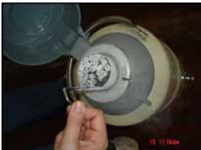
FIGURA 3 | BOCA DE UM BOTIJÃO TIPO DRY SHIPPER COM RACKS ALOCADAS EM UM ÚNICO CANECO PARA O RESFRIAMENTO DO SÊMEN, CARACTERIZANDO A PRÉ-CRIOPRESERVAÇÃO; DUKE ENERGY, SALTO GRANDE, SP, 2005
