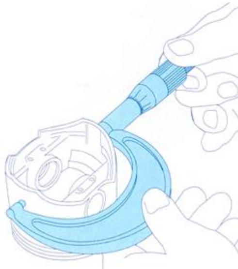
Figura 3.4 – Realizando uma medida com um micrômetro simples.
