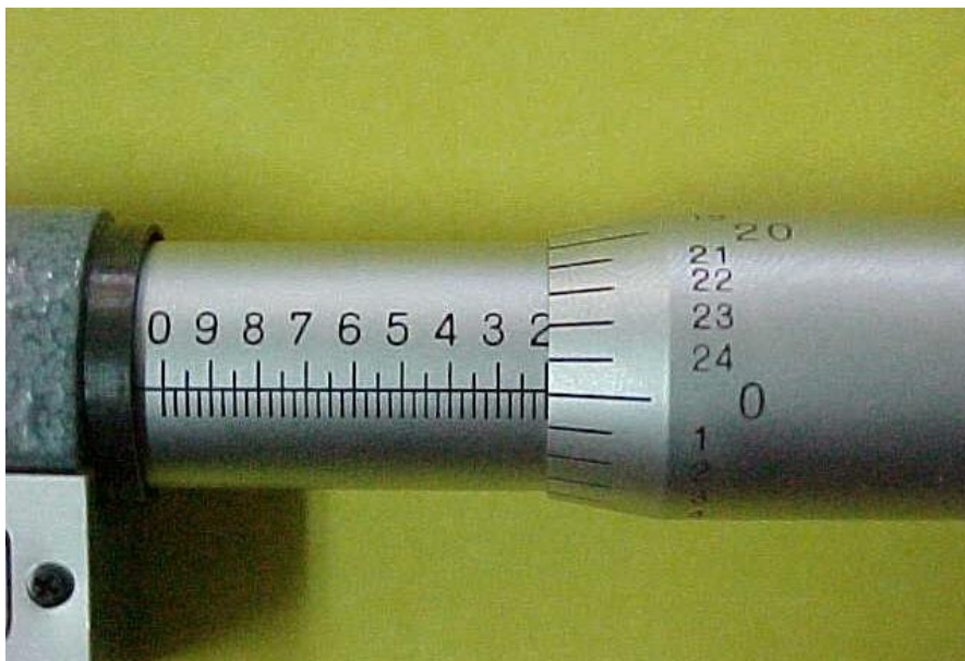
Figura 3.3 – Parafuso micrométrico graduado de um micrômetro simples.
