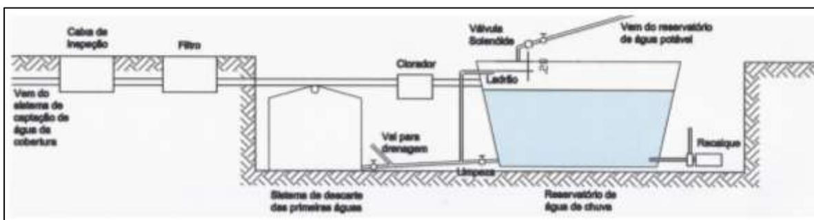
Figura 15 - Sistema de aproveitamento de água da chuva (Extraído de IPT, 2012)
