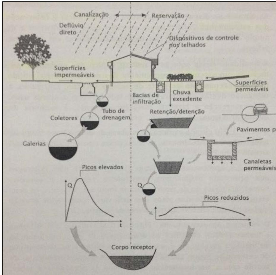
**Figura 20** – Ilustração esquemática dos conceitos de reservação x canalização
