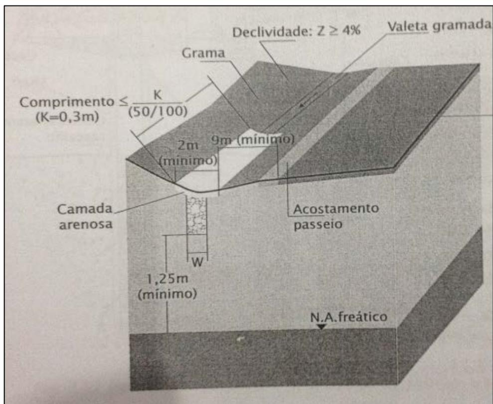
**Figura 22** – Ilustração das dimensões da valeta de infiltração
