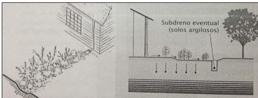
**Figura 21** – Ilustração esquemática de uma vala de infiltração aberta
