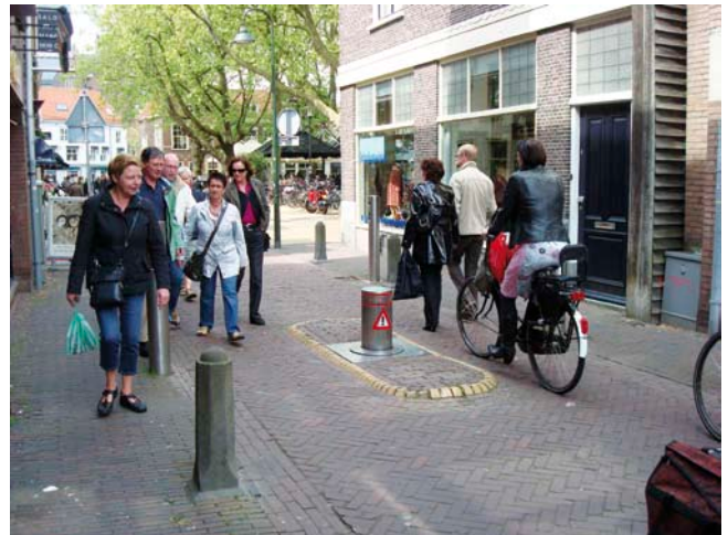
Figura 42. No centro da via, equipamento retrátil para moderação de trânsito em Delft, na Holanda. Foto: TC Urbes, 2009.
