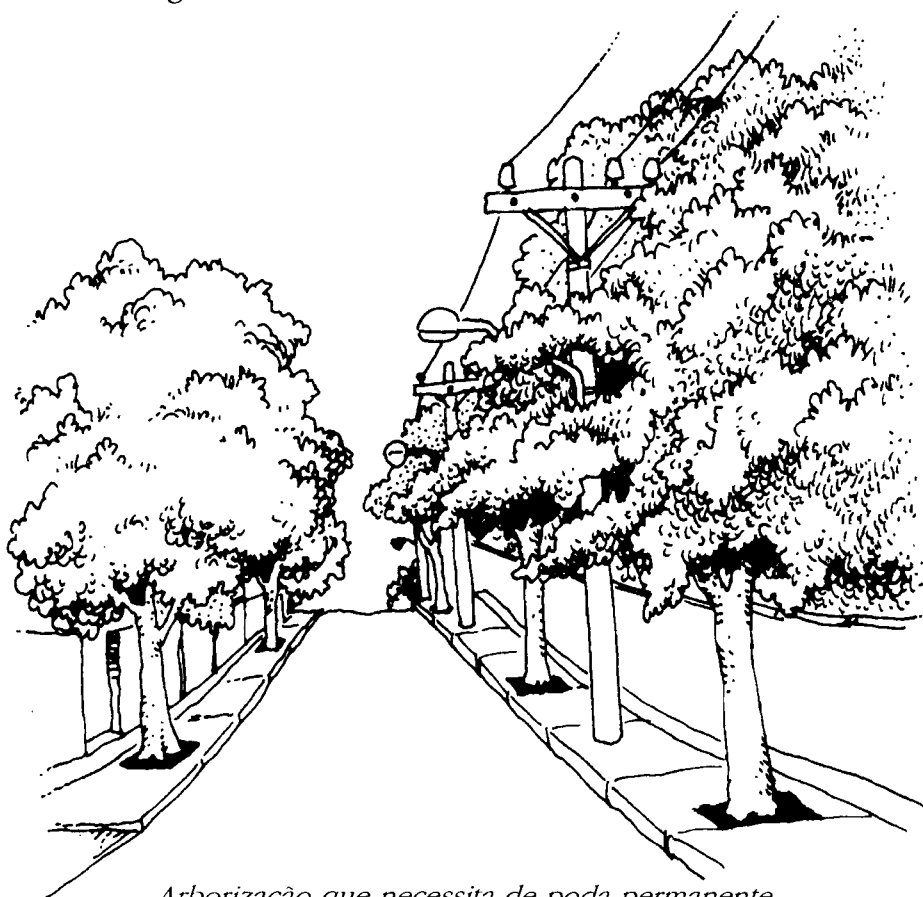
Arborização que necessita de poda permanente
