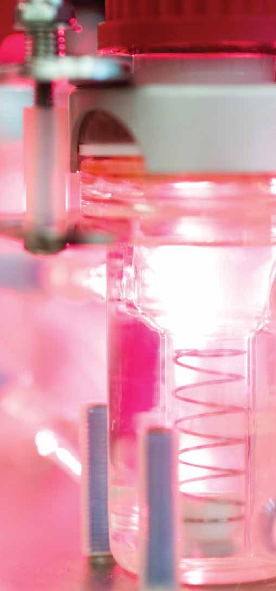
No IPT: detalhe de equipamento que permite medir experimentalmente a penetração das nanopartículas na pele
