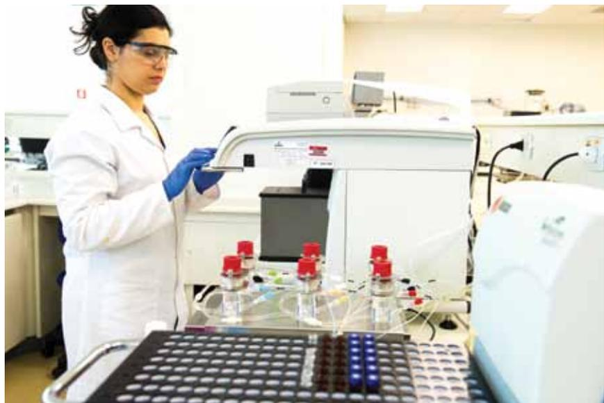
Laboratório de Biotecnologia Industrial do IPT: reator onde se preparam soluções de nanopartículas, ao lado. No alto, pesquisadora opera equipamento de permeação cutânea
