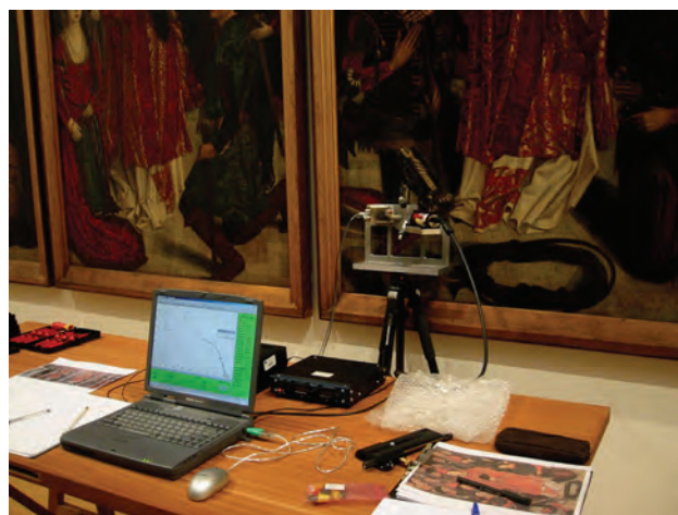
Figura 7 – Análise do Políptico de São Vicente , de Nuno Gonçalves, com equipamento de espectrometria de fluorescência de raios-X portátil
