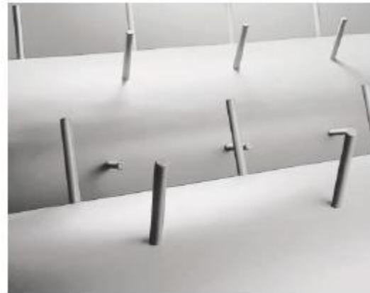
Os dois cilindros do limpador com uma nova disposição dos pinos
