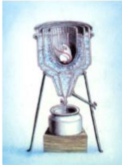
Calorímetro de gelo. Invenção de Lavoisier.
