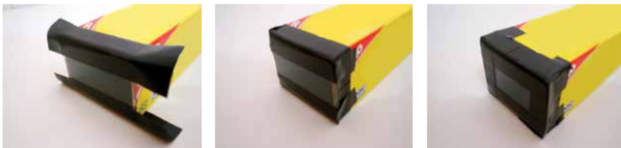
Figura 34 – Descole a fita adesiva do pedaço de CD (a) e cole, em suas laterais, a fita isolante (b). Depois, na lateral da caixa onde a aba superior e a inferior foram cortadas pela metade, cole o pedaço de CD, de modo que a fita isolante cubra essas abas (c) e (d). Dobre as sobras de fita isolante para dar o acabamento (e) e, por fim, vede as outras laterais da caixa, para evitar a entrada de luz (f).
