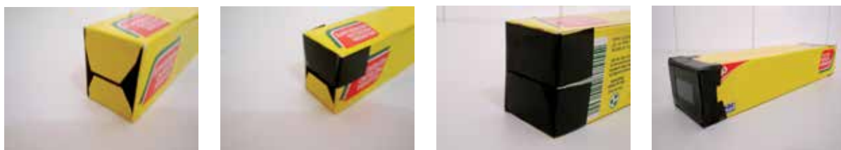
Figura 35 – Na outra lateral da caixa (a), cole duas tiras de fita isolante deixando entre elas um espaço de, no máximo, 1 mm de largura (b) e (c). Pronto! Eis o espectroscópio (d)!
