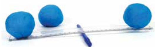
Figura 31 – Procedimento para comparação da massa das esferas de massinha.
