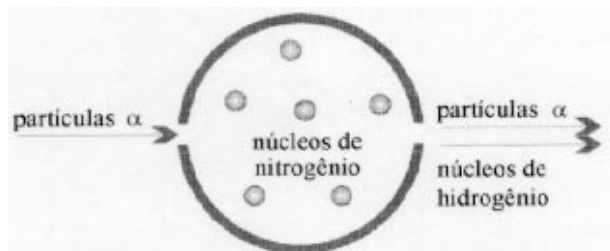
Figura 5: Núcleos de hidrogênio são formados a partir da incidência de partículas alfa em núcleos de nitrogênio.
