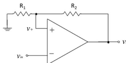
Figura 9 - Circuito de um amplificador na configuração "comparador".
