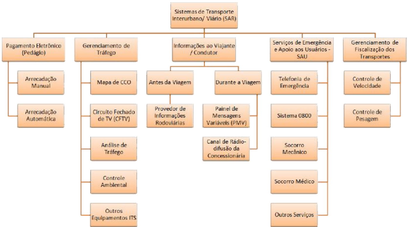
Figura 12 – Grupos de Serviços de ITS em Rodovias (Fonte: PTR2580 – 2º semestre 2013 – Aula 4)
