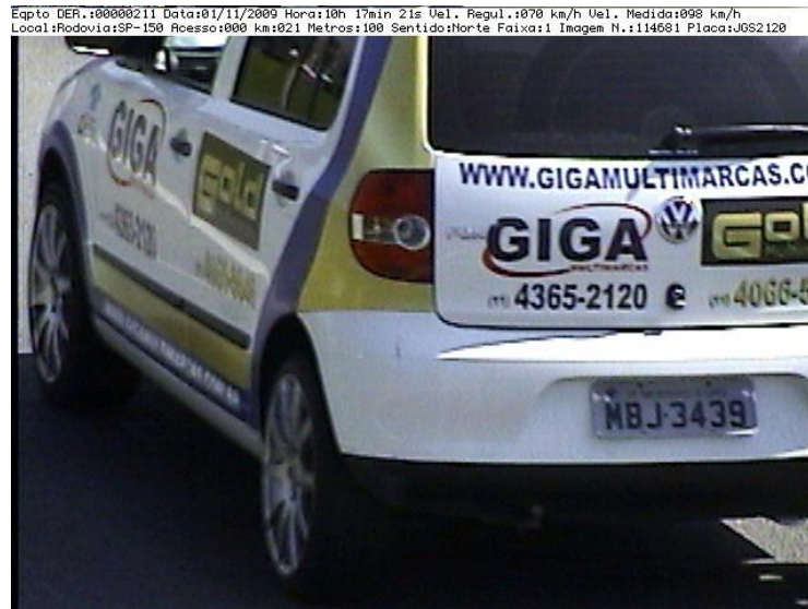
Figura 3 – Erro de extração da placa em função da poluição visual
