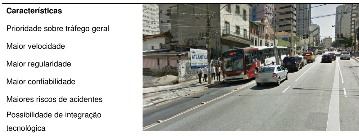
Figura 2-4 - Circulação de ônibus em faixa exclusiva à direita no contra fluxo
