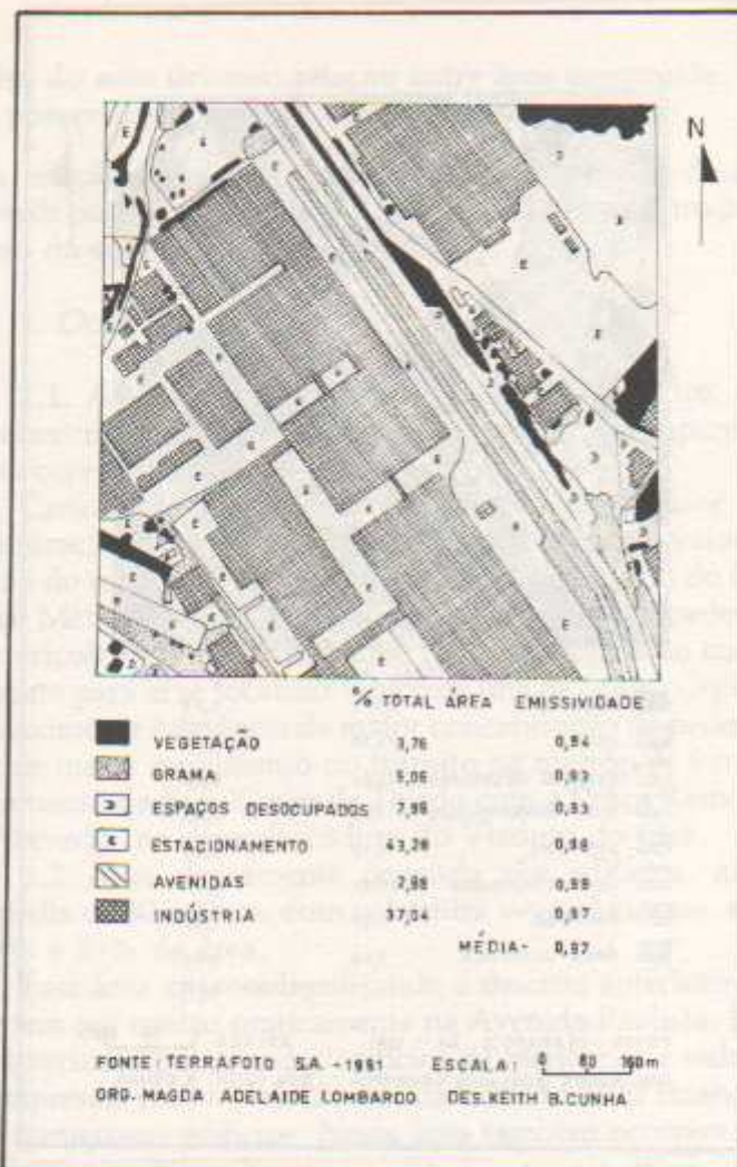
Figura 26. Padrões de uso do solo urbano utilizados para a estimativa de emissividade na amostra 17. Área tipicamente industrial, nas proximidades do rio Grande, com pouca quantidade de áreas verdes. O que se destaca é o adensamento de área construída com barracões fabris (37,04%) e estacionamento (43,28%).
