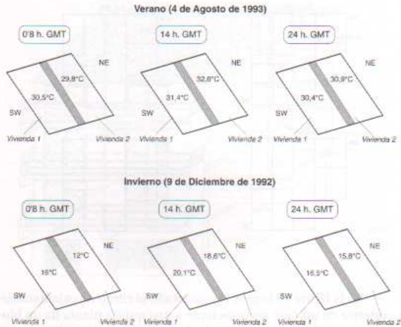
Fig. 57 Ritmo térmico interior de dos viviendas en función de la orientación. Avda. de Granada.
