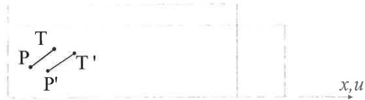
Figura 2.10: Deformação da chapa destacando fibra inclinada
