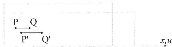
Figura 2.7: Deformação da chapa destacando fibra horizontal
