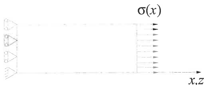
Figura 2.8: Tensão atuante em uma seção genérica.
