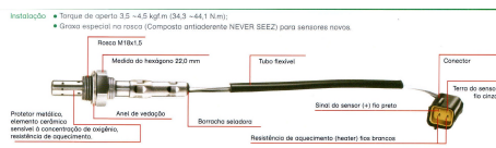
Figura 7.3: Esquema de ligação externo.
