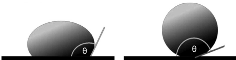
Fig. 6 – Ângulo de contacto de uma gota de água com uma superfície hidrofóbica (>90°) e super-hidrofóbica (>150°)
