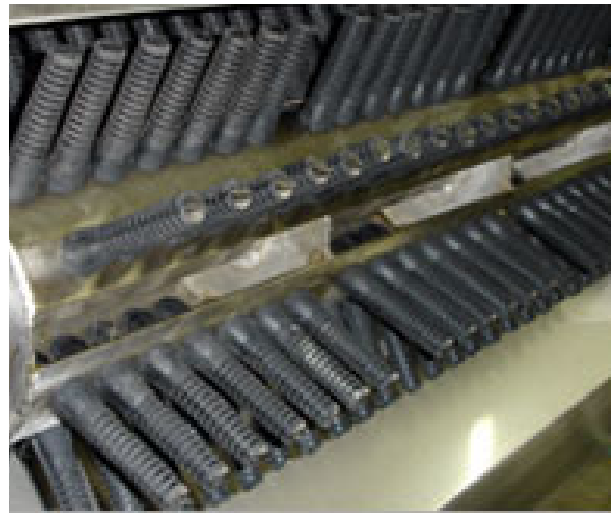
Figura 3. Dedos de borracha de uma depenadeira. Equipamento de difícil higienização, envolvido na disseminação de Salmonella dentro do abatedouro de aves. Em: http://www.grecomaquinas.com.br .
