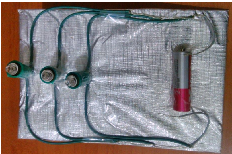
Imagem 5: Circuito em paralelo utilizando três lâmpadas e apenas uma pilha.
