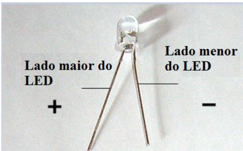
Imagem 1: Esquema de polaridade de um LED. Fonte: www.gentetuning.es , imagem modificada.
