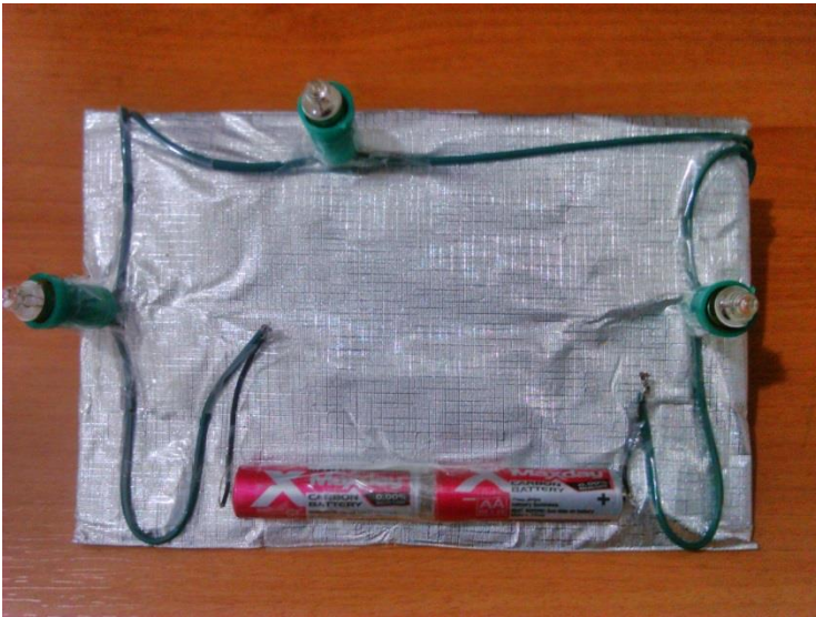
Imagem 4: Circuito em série utilizando lâmpadas pingo d'água.
