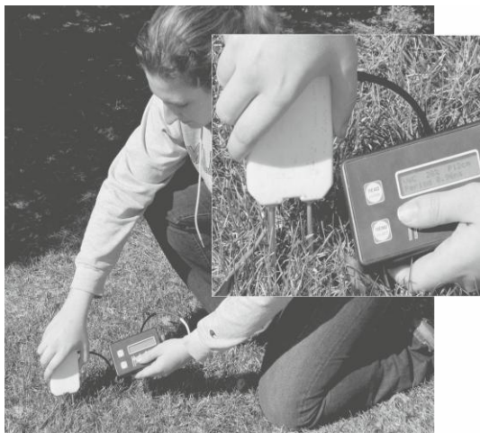
FIGURA 2.14 Medida instrumental do conteúdo de água no solo utilizando a reflectometria no domínio do tempo (TDR). O instrumento envia um pulso de energia eletromagnética abaixo de duas hastes de metal paralelas do guia de ondas que o cientista de solo está empurrando no solo ( foto inserida ). O instrumento TDR faz medições precisas, na ordem de picossegundos, na velocidade com que os pulsos se deslocam abaixo das hastes, uma velocidade influenciada pela natureza do solo circundante. Microprocessadores no instrumento analisam os padrões de onda gerados e calculam a constante dielétrica aparente do solo. Como a constante dielétrica de um solo é influenciada principalmente pelo seu conteúdo de água, o instrumento pode precisamente converter estas medidas em conteúdo volumétrico de água no solo. (Foto cortesia de R. Weil)
