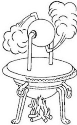
Figura 2: Aerolipa de Hierão de Alexandria
