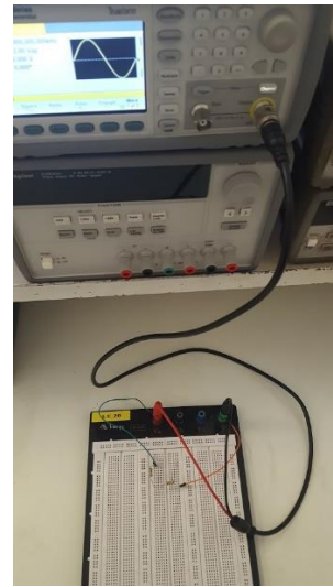
Figura 3: Cabo coaxial com conectores BNC-bananas utilizado na saída do gerador de funções.
