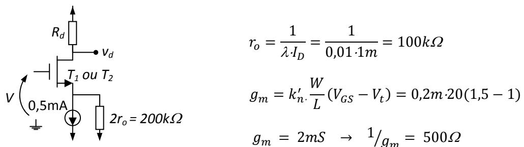
Substituindo o transistor pelo seu modelo T e calculando o ganho em modo comum;
