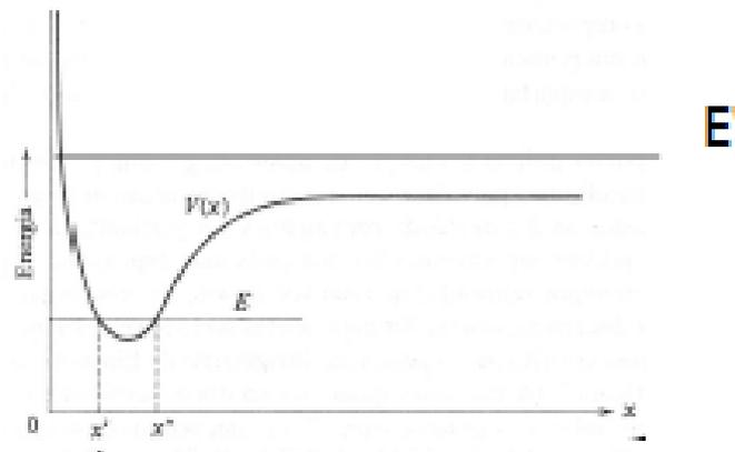
Quando  $E > V(x)$  para qualquer valor de  $x > x'$  é possível encontrar uma solução para  $\psi(x)$  para qualquer valor de energia, formando uma distribuição contínua de valores de energia do sistema
