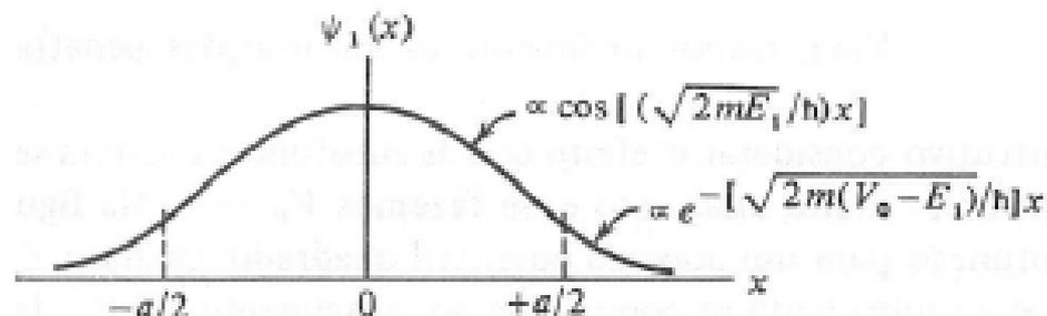
O fato da função de onda não ser zero nas paredes aumenta o comprimento de onda de de Broglie na parede (em comparação com o poço infinito), e isto torna menor a energia e o momento da partícula. Esta observação pode ser usada para aproximar as energias permitidas para a partícula ligada. A função de onda penetra na região exterior, numa escala de comprimento definido pela profundidade de penetração  $\delta$  dado por:
