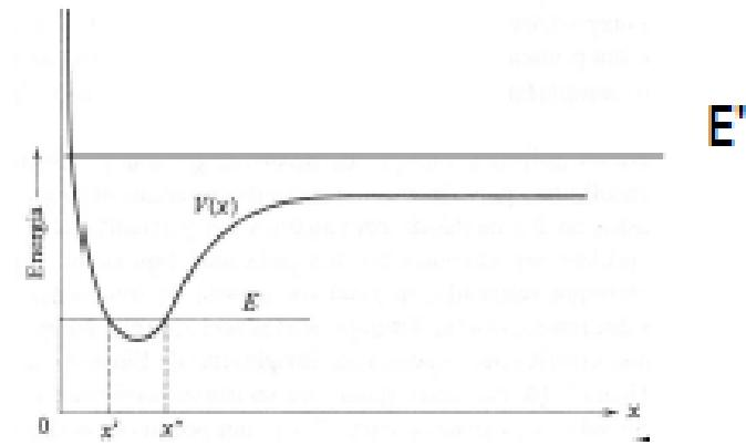
**Quando  $E > V(x)$  para qualquer valor de  $x > x'$  é possível encontrar uma solução para  $\psi(x)$  para qualquer valor de energia, formando uma distribuição continua de valores de energia do sistema**
