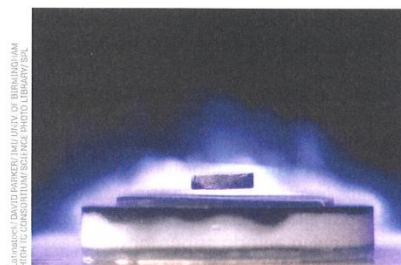
Figura 53: Os materiais supercondutores são capazes de repelir as linhas de força de um campo magnético, característica que explica a levitação do ímã mostrada na imagem.
