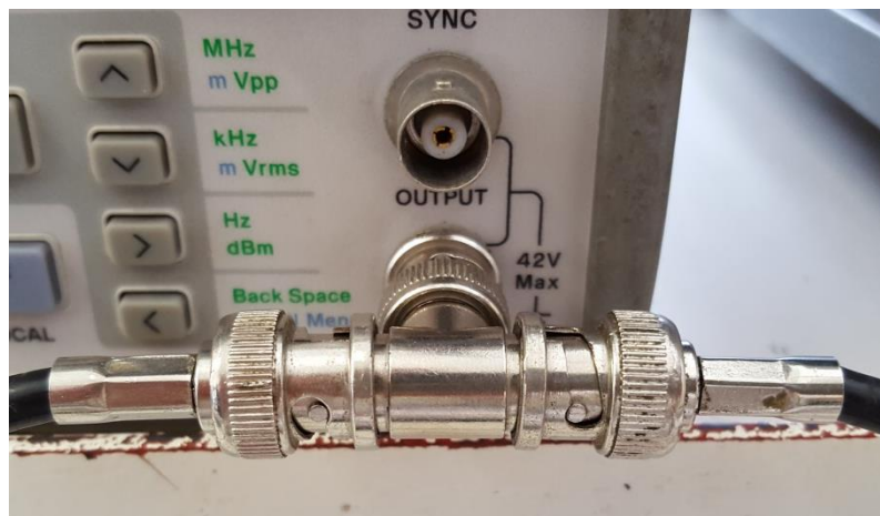
Exemplo de derivação do sinal da saída de um gerador de funções utilizando-se o adaptador tipo T
