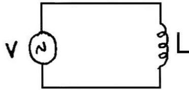
Figura 6.5: Um indutor ligado a uma fonte de tensão alternada.
