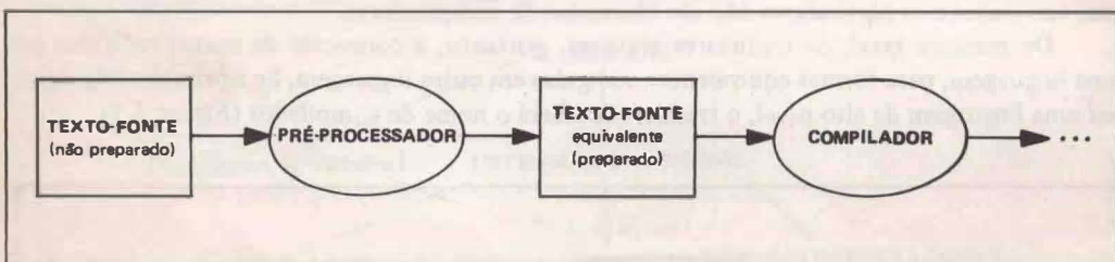
Figura 1.5 – Um pré-processador como preparador de texto para a compilação.
