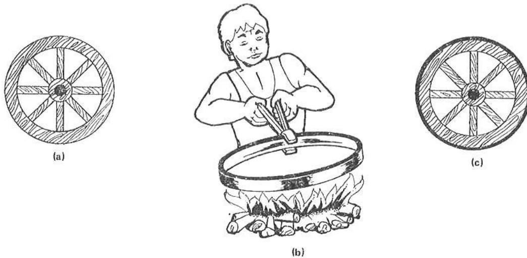
Fig. 2 – A fig. (a) mostra uma roda de carroça sem a parte metálica exterior. Aquece-se a cinta metálica – fig. (b). A cinta é colocada na roda e ao esfriar fixa-se solidamente na mesma – fig. (c).
