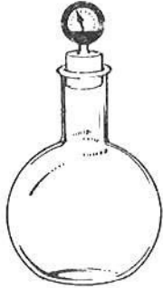
Fig. 1 – A figura mostra um recipiente contendo um gás num determinado estado térmico e um dispositivo que mede a pressão desse gás. O recipiente encontra-se hermeticamente fechado.
