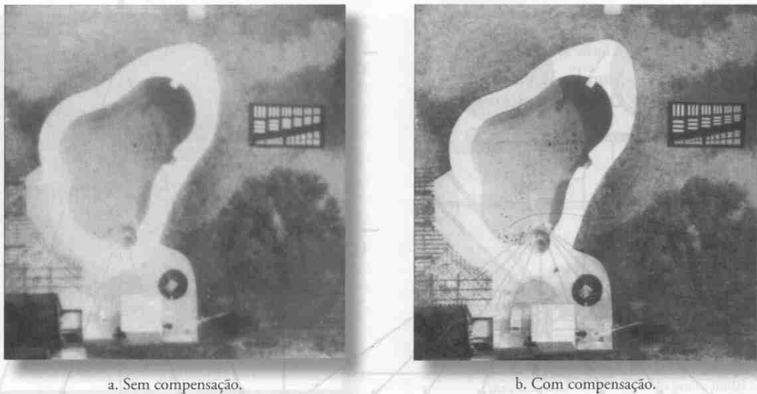
Figura 4-11 a) Fotografia aérea vertical de uma piscina obtida sem compensação do movimento de arraste da imagem. Observe o quadro para teste de resolução espacial que está do lado da piscina. b) Fotografia obtida com compensação do movimento de arraste da imagem. Mais elementos podem ser discernidos no quadro de resolução (cortesia E. Coyote Enterprises, Inc., Marilyn O'Cuilinn; Z/I Imaging).
