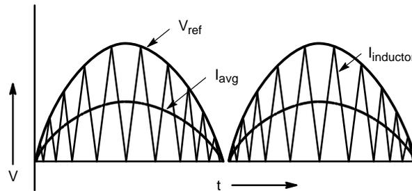
Figure 1-9. CrM Waveforms
