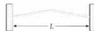
FIGURA 16-22 Uma corda dedilhada no centro. Quando liberada, sua vibração é uma superposição linear de ondas estacionárias.
