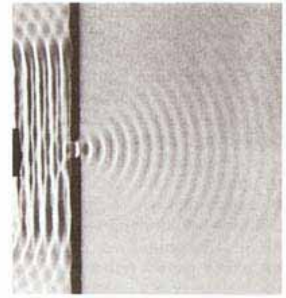
FIGURA 15-23 Ondas planas, em um tanque de ondas, encontrando uma barreira com uma fenda cujo tamanho é aproximadamente de um comprimento de onda. Depois da barreira, as ondas são circulares concêntricas em torno da fenda, como se existisse uma fonte pontual na fenda. ( Fundamental Photographers. )
