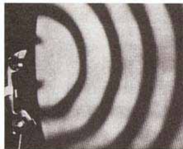
Ondas sonoras emitidas por um aparelho telefônico e propagando-se no ar. As ondas foram feitas visíveis varrendo-se o espaço em frente ao aparelho com uma fonte de luz cujo brilho é controlado por um microfone. (De Winston E. Kock, Lasers and Holography , 1978, Dover Publications, New York.)
