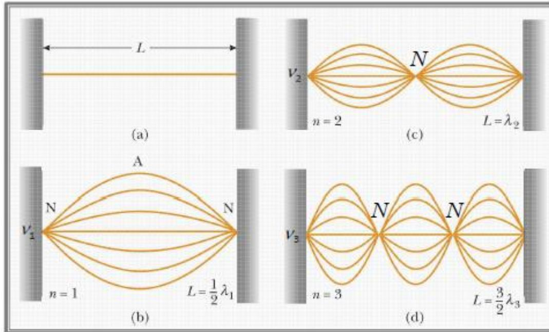
*Modo de ordem  $n$ : contém  $(n-1)$  nodos e  $n/2$  comprimentos de onda*
