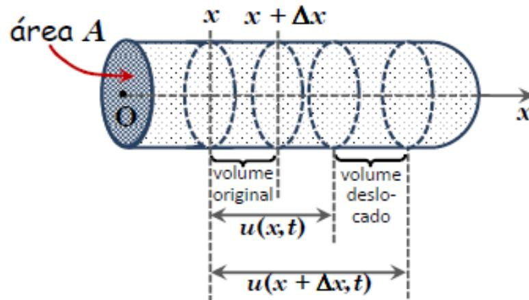
$u(x, t) \Rightarrow$  deslocamento sofrido pelas partículas do fluido na seção transversal (área  $A$ ) de coordenada  $x$  no instante  $t$
