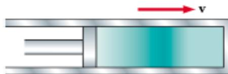
Movimento de um pulso longitudinal através de um gás compressível. A região escura (comprimada) é produzida pelo movimento do pistão.
