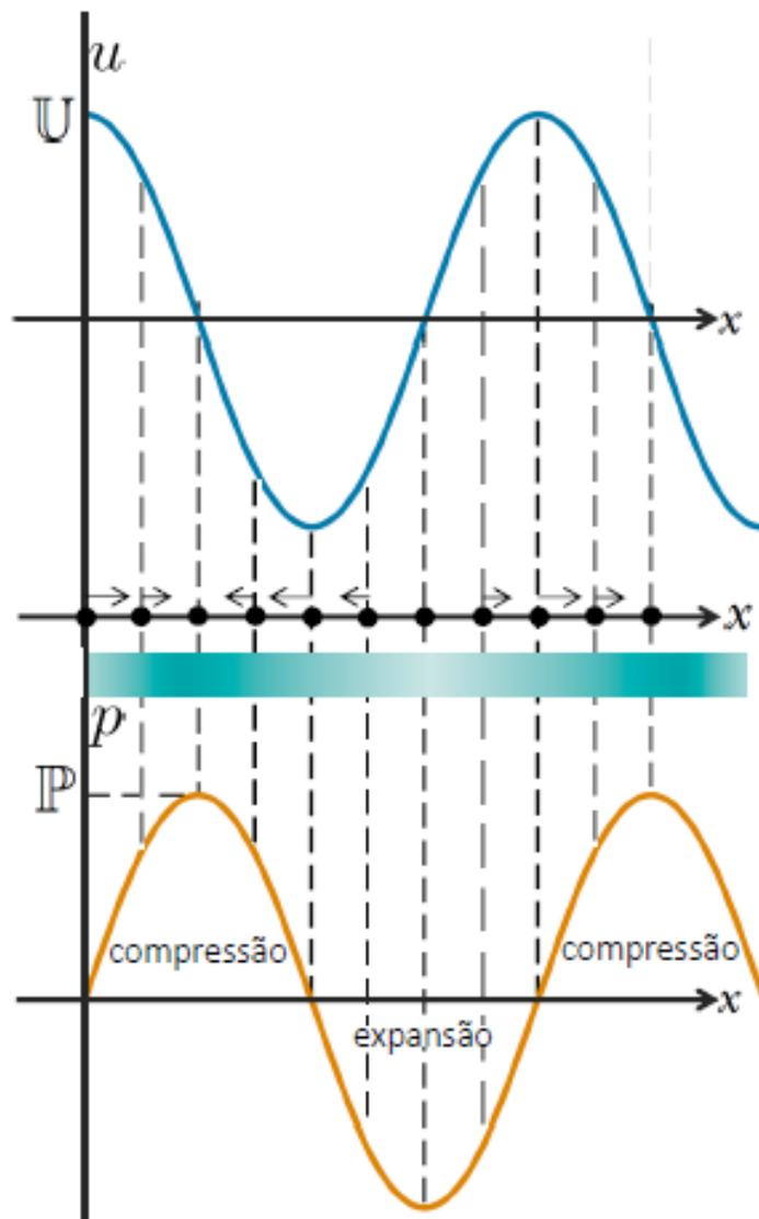
As ondas de deslocamento  $u$  e as ondas de pressão  $p$  estão em quadratura, ou seja, defasadas de  $90^\circ$
