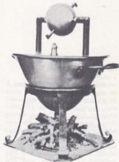
Um modelo da colipila de Herão. O vapor produzido na caldeira sai pelos orifícios da esfera, obrigando-a a girar.
