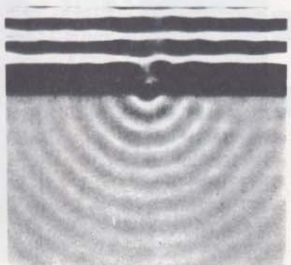
Difracção de ondas através de uma abertura estreita.
