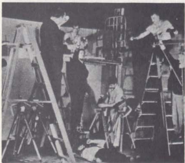
Fig. 4 As sete bolas dispersadas são seguras para evitar que os fios de que estão suspensas se entrelacem. O fotógrafo e a máquina fotográfica estão no chão. Vêem-se os quatro estroboscópios montados nos tripés na parte inferior da fotografia.
